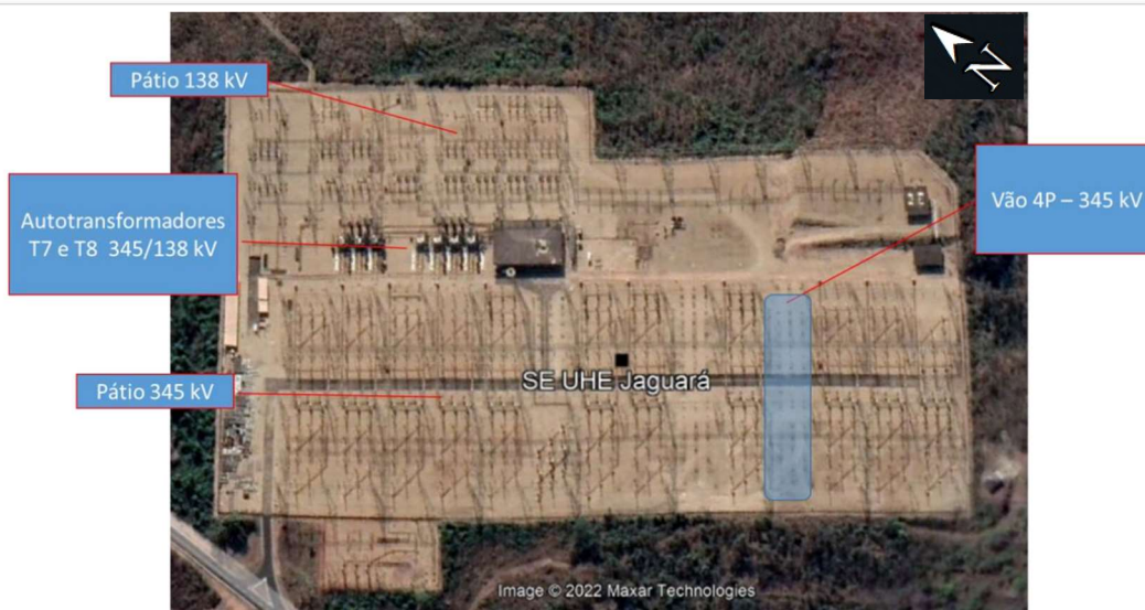
Figura 4 – Vão disponível na SE UHE Jaguará, conforme configuração do relatório EPE-DEE-RE-008/2023-rev0
