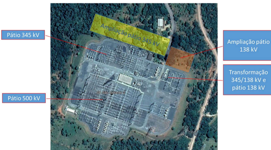
Figura 2 – Configuração atual e área de expansão da SE São Gotardo 2, obtida no EPE-DEE-RE-008/2023-rev0
